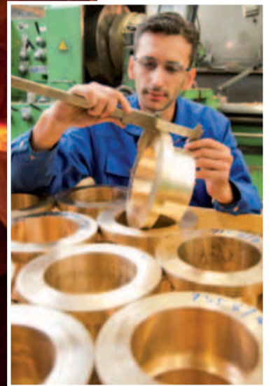
Präzision: Odysseus Verdinoglou prüft die Maße eines gegossenen Metallrings.
