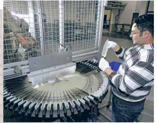
Hightech hinter Gittern: Roboter stellen bei Wüsthof das Gros der Messer mit dem berühmten Markenzeichen „Dreizack“ her.
