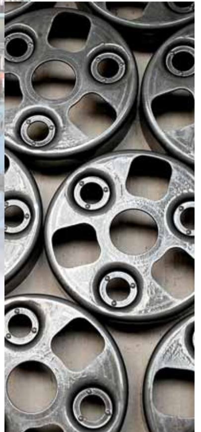
Tolles Teil: Tilgerbleche für die Kardanwelle des Audi TT, frisch aus der Presse. Fotos: Wirtz (3)
