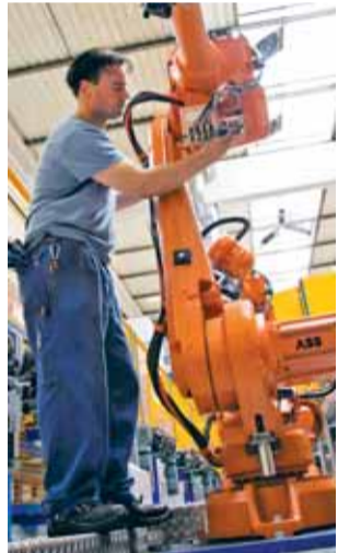
Hightech in Hagen: Suvad Durakovic an einer neuen Laserschweißanlage, die den Bau extrem leichter Lehnen ermöglicht.
