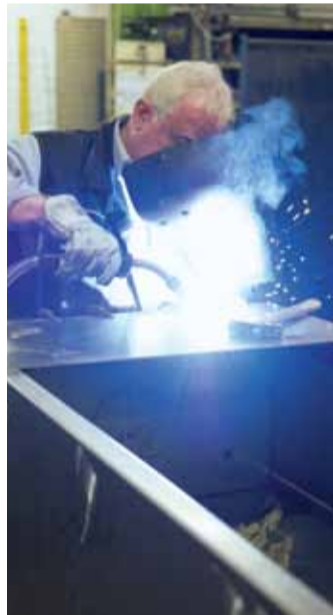
Präzisionsjob: Walter Alex beim Schweißen von Wertschutztüren für eine Safeanlage.
