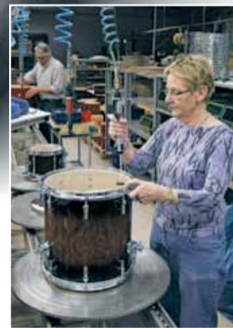
Endmontage: Christa Knoche schraubt die Metallbeschläge an und setzt die Felle auf.
